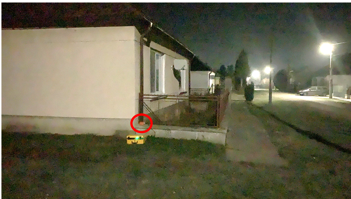
Místo měření M6: technické místo měření, plot s podezdívkou u rodinného domu Hrušov 1104 s umístěním snímače vibrací
